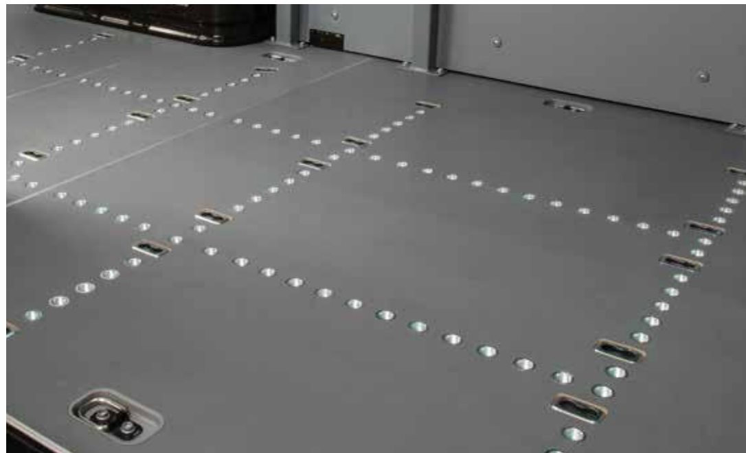
SAFETY CROSS: Bevestigingspunten in lengterichting en dwarsrichting op aanvraag. SAFETY CROSS: longitudinal and transversal fixing points upon request.
